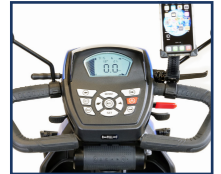
Panneau de contrôle avec écran ACL, support pour cellulaire et barre de son Bluetooth
