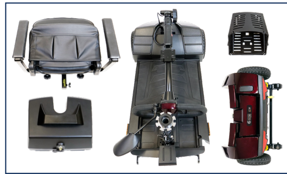
Démonté pour transport
